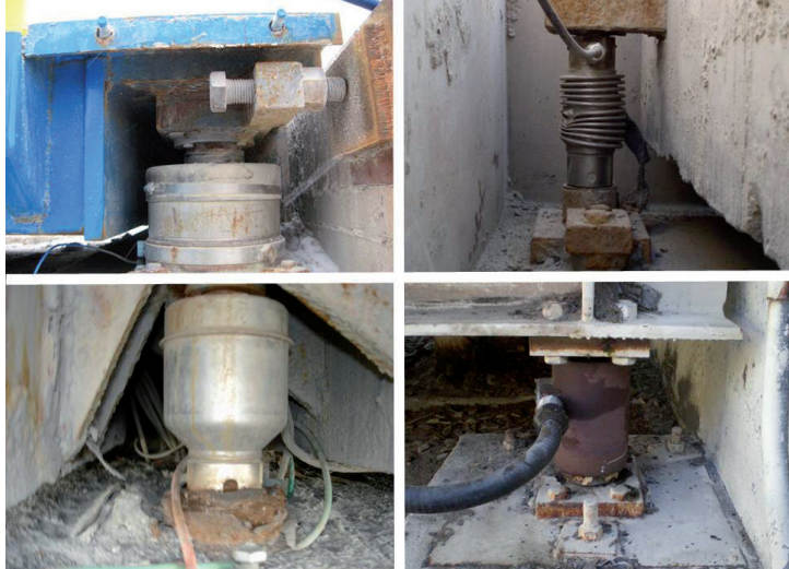
Föråldrade lastcellssystem kan orsaka upprepade fordonsvågsproblem.
