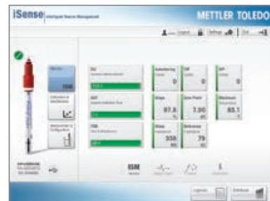
Le logiciel iSense<sup>™</sup> permet d'étalonner les sondes à l'aide d'un PC ou d'un appareil mobile pour les raccorder ensuite au M100 DR. Il n'est donc pas nécessaire d'avoir recours à une interface utilisateur sur le terrain.
