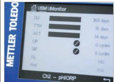
Les fonctions de maintenance prédictive ISM permettent d'obtenir des diagnostics sur les sondes. Grâce à ces informations, les tâches de maintenance sont réduites et le risque d'arrêts non planifiés est évité.
