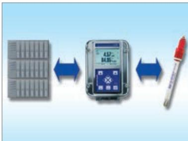
Dotés de la technologie ISM, les transmetteurs M700 permettent une intégration transparente des diagnostics de sondes vers les systèmes de contrôle du procédé via Profibus PA et FOUNDATION fieldbus.
