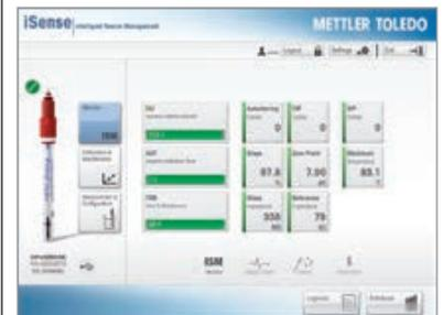
Le logiciel iSense™, outil essentiel de la technologie ISM, permet de pré-étalonner les sondes à l'aide d'un PC pour les raccorder ensuite au M100. Il n'est donc plus nécessaire d'avoir recours à une interface utilisateur sur le terrain. Ce nouveau concept de transmetteur permet de réduire les efforts liés à l'utilisation et au câblage au minimum.
