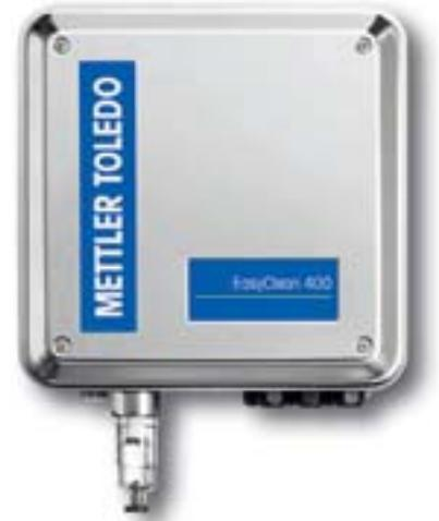
EasyClean 400はpH測定箇所の全自動洗浄と校正を行います。変換器M 700をInTrac 7XX e着脱式ホルダと組み合わせることで、連続測定やバッチ測定で使用できる柔軟なシステムソリューションを提供できます。
