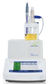
การกำหนดปริมาณน้ำด้วยการไทเทรตแบบ Karl Fischer
