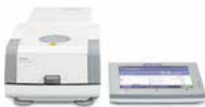
ハロゲン水分計による水分率測定
