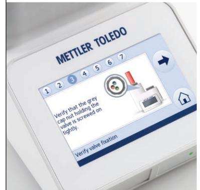
EasySetup le guía paso a paso por el menú de instalación. La configuración y el desarrollo de la aplicación se simplifican mediante una programación intuitiva y exhaustiva.
