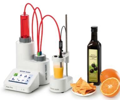
Mediante la combinación de tres tipos principales de valoraciones: ácido/base, precipitación y redox, este instrumento determina los parámetros más habituales en los alimentos, las bebidas y los productos químicos.
