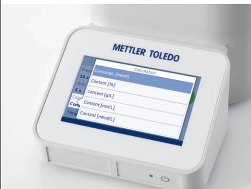
El valorador EasyPlus™ calcula automáticamente los resultados mediante fórmulas predefinidas. METTLER TOLEDO ha programado las fórmulas de cálculo más habituales. Solo tiene que seleccionar la unidad de los resultados y permitir que el instrumento haga el resto.
