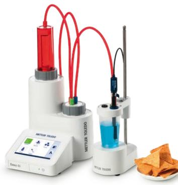
Todo lo que necesita para la determinación del cloruro en los alimentos y otros productos, más la determinación del contenido de plata mediante precipitación.
