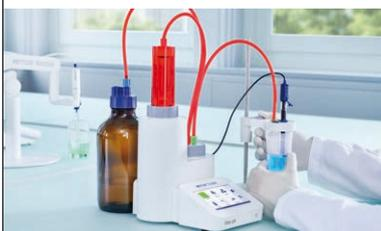
Grâce aux fonctions intelligentes intégrées, quelques réglages suffisent pour que l'instrument soit prêt au titrage.
