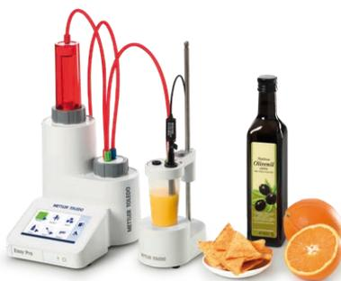
Nos titreurs permettent d'effectuer trois types de titrage : acide/base, précipitation et rédox. Cet instrument détermine les paramètres les plus courants dans les aliments, les boissons et les produits chimiques.
