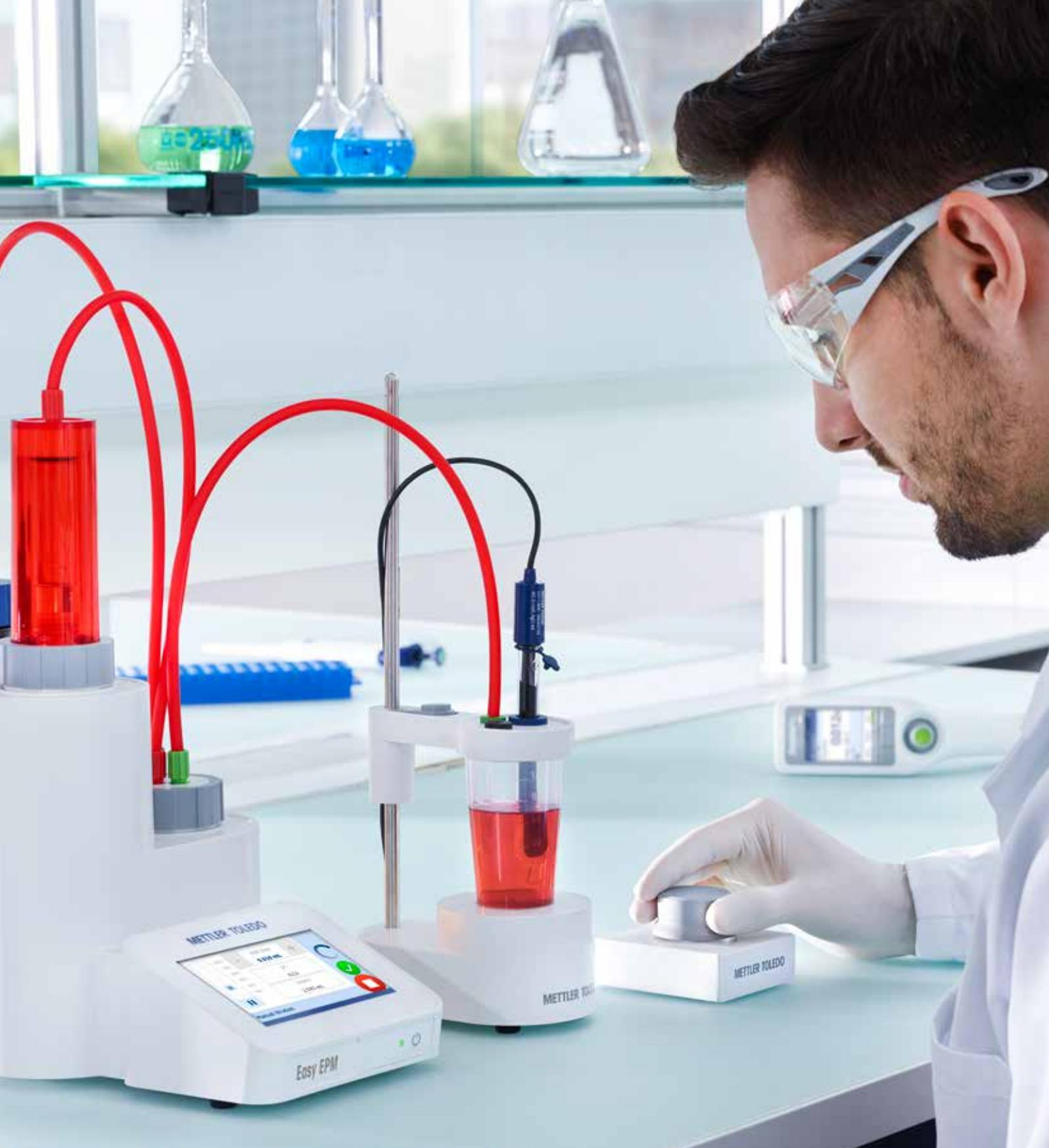
pH-Wert und Säuregehalt spielen bei der routinemässigen Qualitätskontrolle eine wichtige Rolle. Ob Sie nun Milch, Orangensaft, Öle oder Schmierstoffe analysieren, der Easy EPM ist die richtige Wahl für Ihre Analyse. Ein optionaler pH-Sensor führt Sie durch die manuelle Titration, minimiert das Risiko einer Übertitration und kann auch für direkte pH-Messungen eingesetzt werden.
