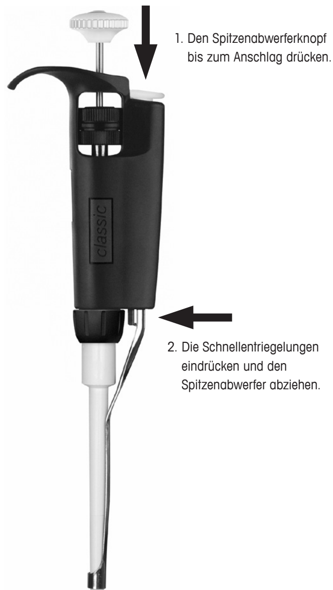
Abbildung 5: Abnehmen des Spitzenabwerfers
