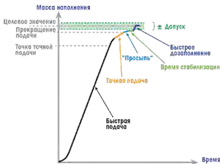
Рис. 25. Работа двухскоростной системы наполнения
