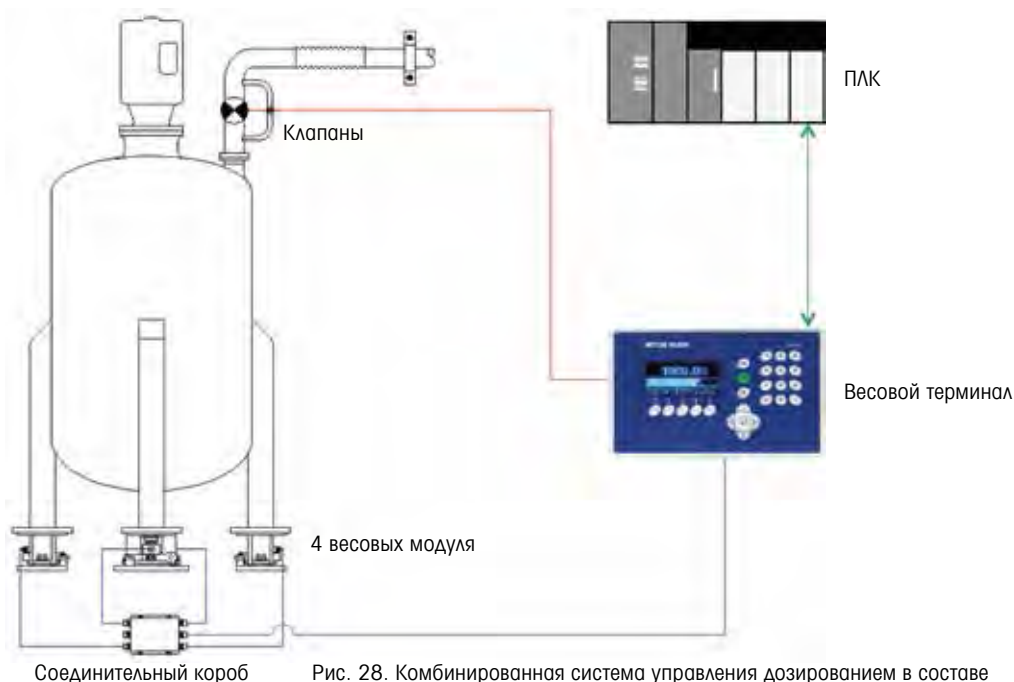
Рис. 28. Комбинированная система управления дозированием в составе ПЛК и весового терминала.
